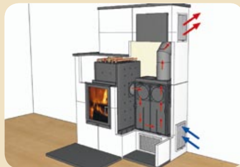
... als Kesselgerät (mit Anbindung an das Heizungssystem) und Nachheizkasten.
